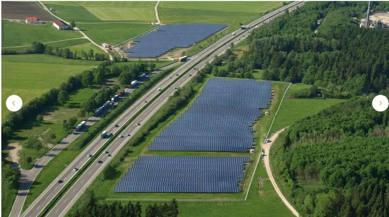
**Solarpark Tuningen:** Leistung und Fläche: 4,5 MWp auf 6,4 ha; Jahreserzeugung: ca. 5,0 Mio. kWh; CO<sub>2</sub>-Einsparung: ca. 3.500 Tonnen pro Jahr; produziert Strom für ca. 1.400 Haushalte; Inbetriebnahme: Mai 2017.
