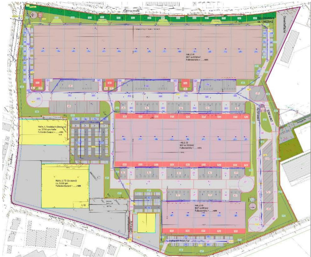
**Abbildung 14: Auszug aus dem Entwässerungskonzept Niederschlagswasserbeseitigung HPC (Stand: 16.04.2020)<sup>17</sup>**
