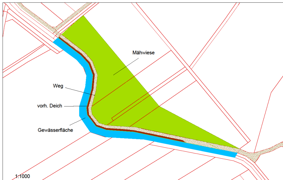
Abb. 22: Deichrückverlegung an der Schwalm, ist-Zustand (Schwalmverband 2020)
