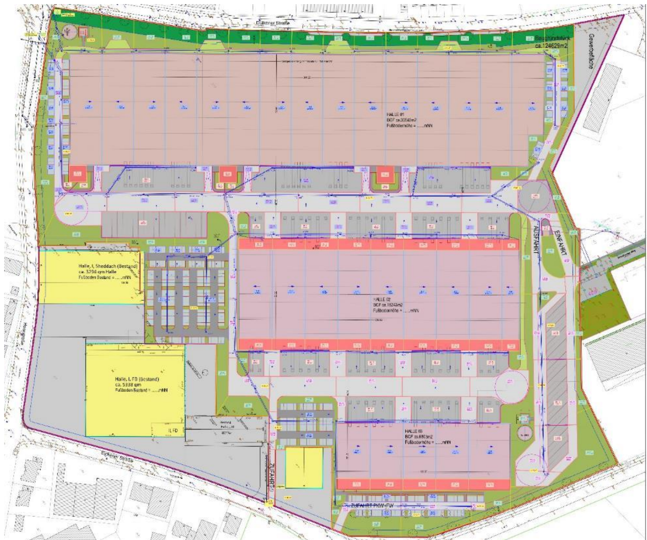
Abbildung 15: Auszug aus dem Entwässerungskonzept Niederschlagswasserbeseitigung HPC (Stand: 16.04.2020) 21
