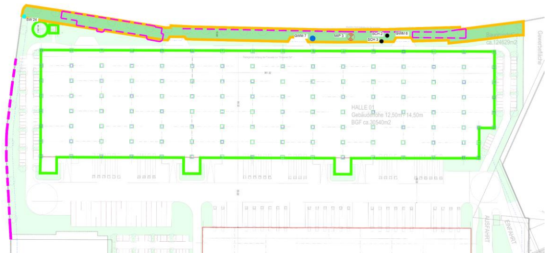
Abb. 6: Bauabschnitt 1b; Abbruch entlang der Dülkener Straße und Herrichtung des Grünstreifens
