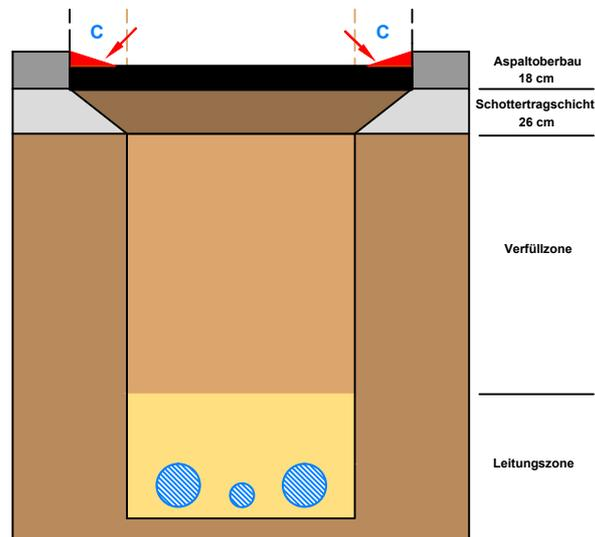
1. 14cm Asphalttragschicht 0/22 einbauen
