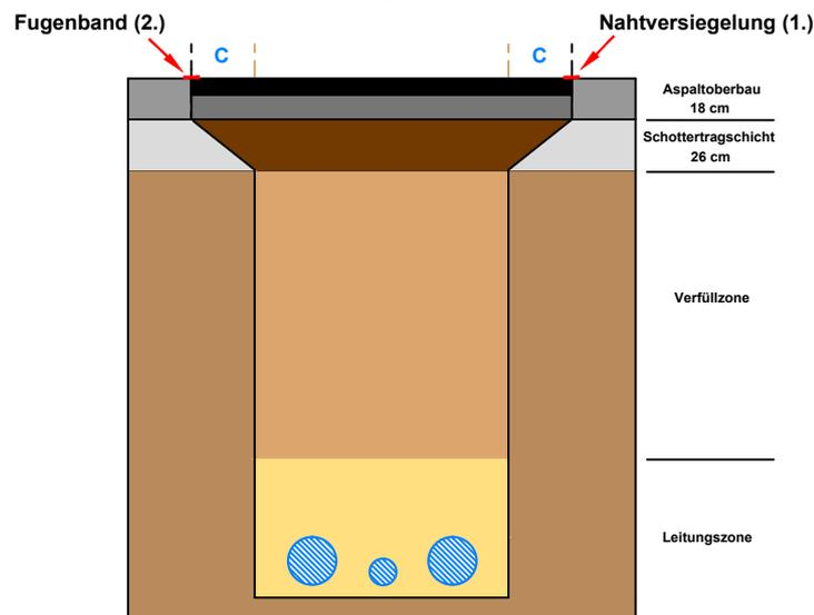
1. gefräste Ränder und Fräsflächen mit Bitumenemulsion anspritzen
