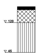
4 cm Asphaltdeckschicht
